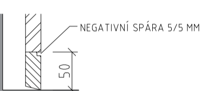
⑩ DÝHOVANÝ OBKLAD, DÝHA DUB KOUŘOVÝ NA DESCE S TŘÍDOU REAKCE NA OHĚN NEJMÉNĚ B-S1-D0, S INDEXEM ŠÍŘENÍ PLAMENE IS = 0 mm/min. (NAPŘ. NEHOŘLAVÁ DTD DESKA), ZAVĚŠENO NA STĚNĚ. CELKOVÁ TL. 50 MM, KRESBA DÝHY SVISLE
