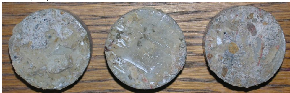
Obr.F45-605 Zkušební terče číslo 24, 30, 110 (zkušební místo 5) po provedení odtrhu.
