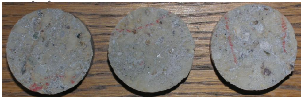
Obr.F45-611 Zkušební terče číslo 7, 78, 121 (zkušební místo 11) po provedení odtrhu.
