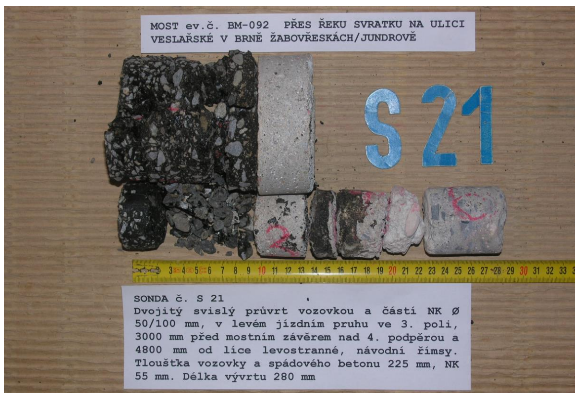
Obr.F45-402 Sonda č. S 21. Dvojité svislý průvrt vozovkou a částí NK Ø 50/100 mm, v levém jízdním pruhu ve 3. poli, 3000 mm před mostním závěrem nad 4. podpěrou a 4800 mm od líce levostranné, návodní římsy. Délka vývrtu 280 mm.
