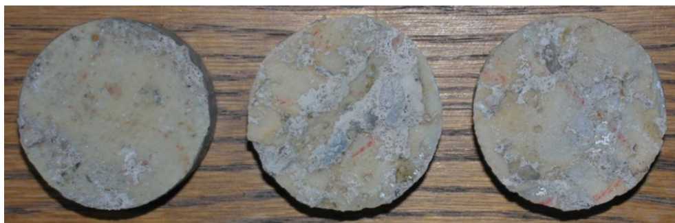
Obr.F45-603 Zkušební terče číslo 63, 72, 112 (zkušební místo 3) po provedení odtrhu.
