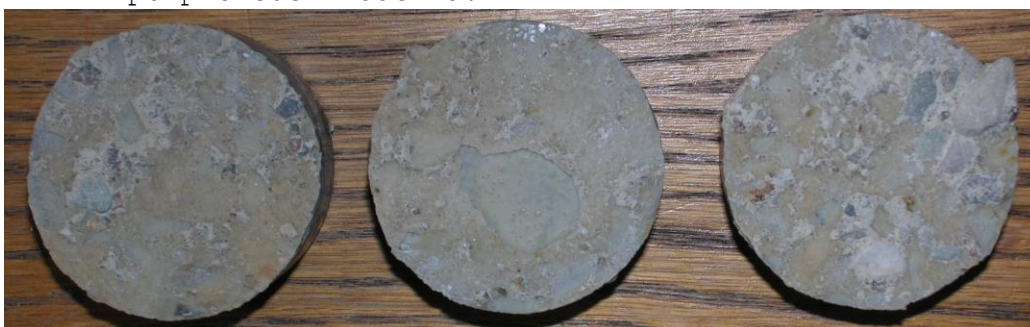
Obr.F45-610 Zkušební terče číslo 20, 36, 104 (zkušební místo 10) po provedení odtrhu.
