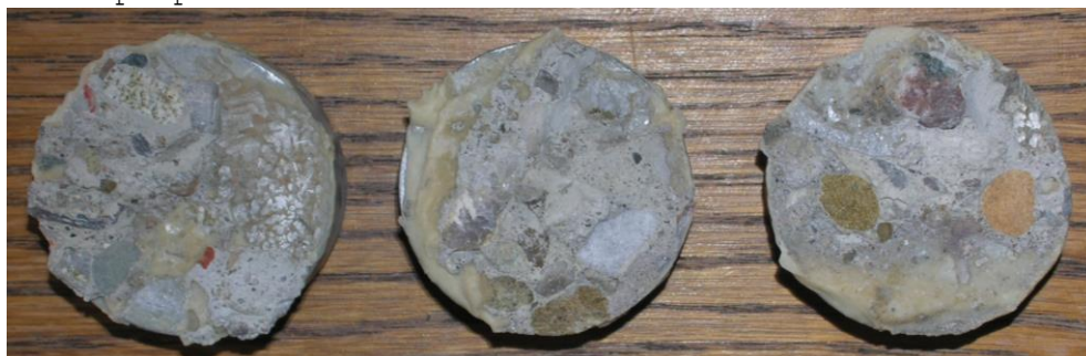
Obr.F45-604 Zkušební terče číslo 38, 65, 132 (zkušební místo 4) po provedení odtrhu.
