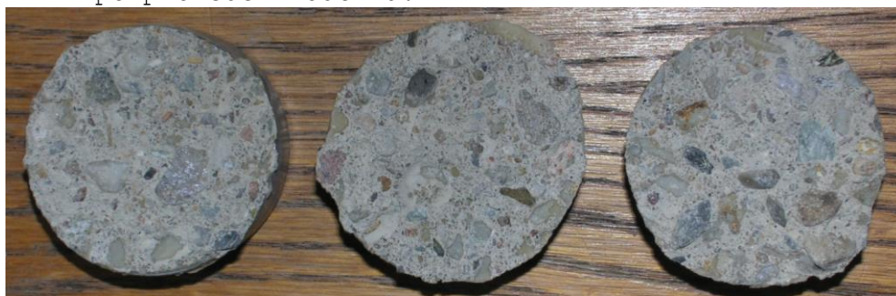
Obr.F45-609 Zkušební terče číslo 74, 91, 98 (zkušební místo 9) po provedení odtrhu.
