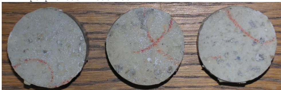
Obr.F45-612 Zkušební terče číslo 19, 81, 136 (zkušební místo 12) po provedení odtrhu.
