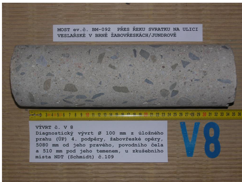
Obr. F45-508 VÝVRT č. V 8. Diagnostický vývrt Ø 100 mm z úložného prahu (ÚP) 4. podpěry, žabovřeské opěry, 5080 mm od jeho pravého, povodního čela a 510 mm pod jeho temenem, u zkušebního místa NDT (Schmidt) č. 109.
