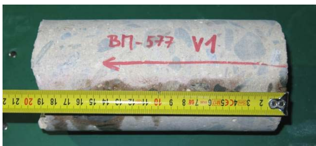
Obr. 4.4: Vývrt V1 odebraný z opěry O1.
