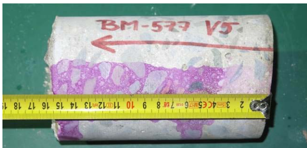
Obr. 4.8: Vývrt V5 odebraný z opěry O2.
