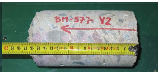
Obr. 4.5: Vývrt V2 odebraný z opěry O1.
