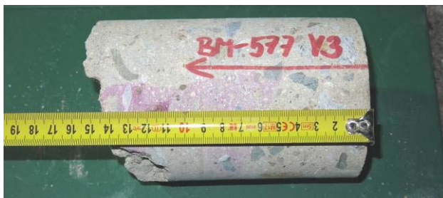
Obr. 4.6: Vývrt V3 odebraný z opěry O1.
