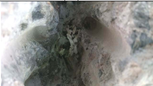
Obr. 4.27: Odhalení předpínacího kabelu K3-6.
