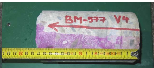
Obr. 4.7: Vývrt V4 odebraný z opěry O2.
