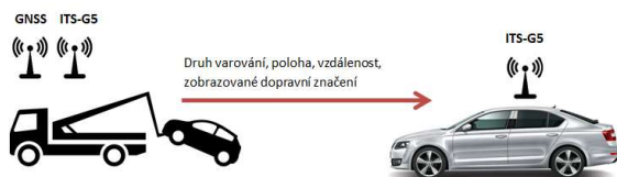
Obrázek 11 Schéma fungování služby RWW – lokální režim
