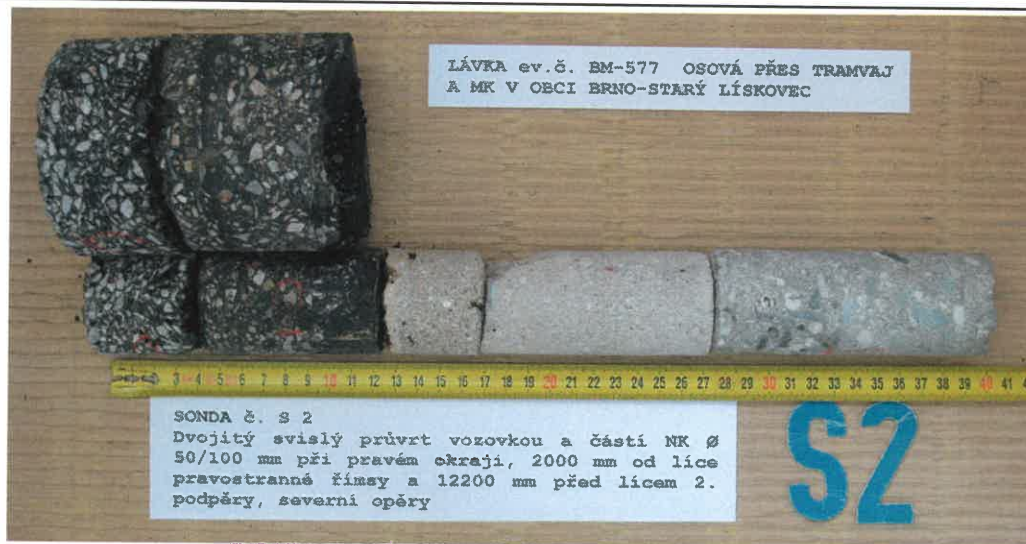
Obr. E63-1: SONDA č. S2. Dvojitý svislý průvrt vozovkou, vyrovnávací/spádovou vrstvou a částí NK ø50/100 mm asi v polovině rozpětí, 12200 mm před lícem 2. podpěry (severní opěry) a 2000 mm od líce pravostranné (východní) římsy. Tloušťka vozovky a spádové vrstvy je 270 mm, celková délka vřvtu 395 mm.
