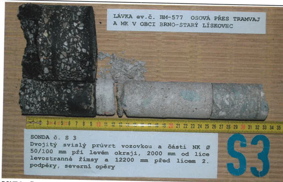
Obr. E63-2: SONDA č. S3. Dvojitý svislý průvrt vozovkou, vyrovnávací/spádovou vrstvou a částí NK ø50/100 mm asi v polovině rozpětí, 12200 mm před lícem 2. podpěry (severní opěry) a 2000 mm od líce levostranné (západní) římsy. Tloušťka vozovky a spádové vrstvy je 250 mm, celková délka vývrtu 320 mm.
